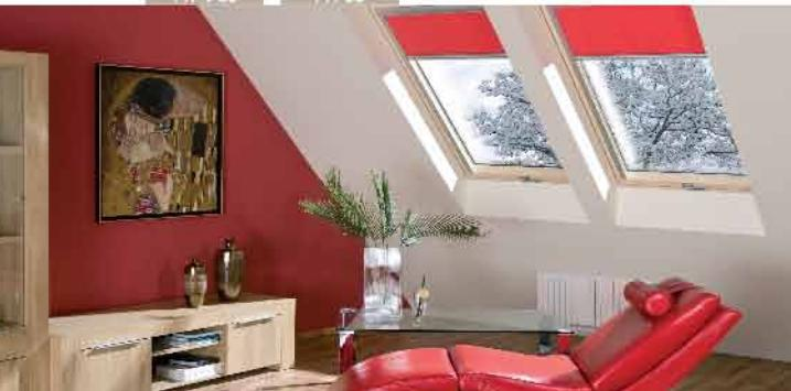
Суперэнергосберегающие окна для крыши **Thermo** – эксклюзивная разработка компании FAKRO специально для холодного климата России. Окно со среднеповоротным открыванием **FTP-V U5** оснащено двухкамерным морозостойким стеклопакетом (3 закаленных стекла). Заполнение пространства между стеклами инертным газом криптоном обеспечивает высокие параметры теплоизоляции.
