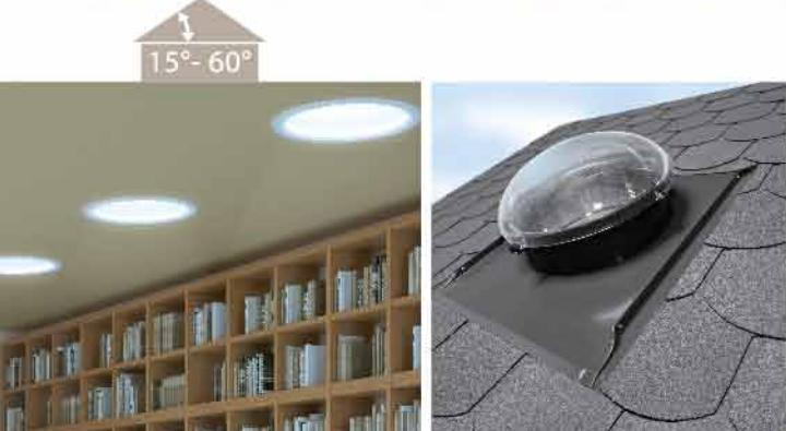
**Туннель дневного света SLT** устроен следующим образом: через купол, встроенный в крышу, дневной свет попадает в светоотражающую гофрированную трубу, которая заканчивается на другом конце рассеивателем света и потолочным плафоном. Благодаря наличию рассеивателя в плафоне помещение равномерно освещается дневным светом. Это позволяет ограничивать расход электроэнергии. При необходимости освещения помещения в ночное время суток в туннель может быть вмонтирована электролампа.
