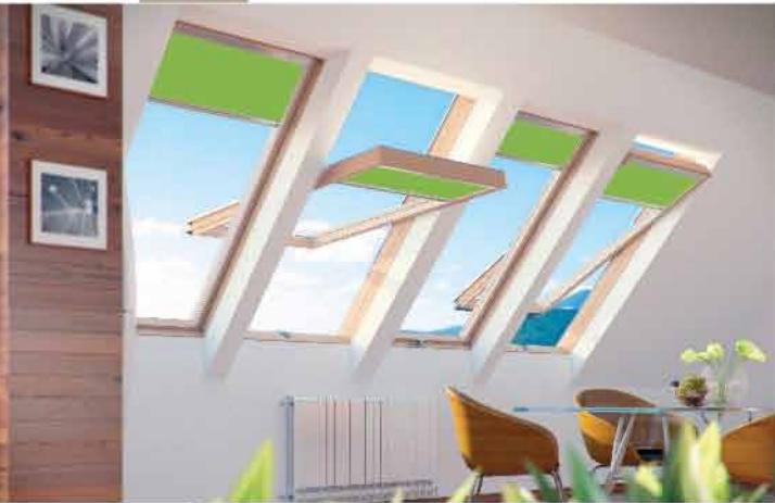
**Окно FT со среднеповоротным открыванием** – самая популярная и доступная модель окна для крыши. Благодаря петлям, расположенным в центральной части оконной коробки, створку окна можно оставлять в позиции наклона, а также поворачивать вокруг оси на 180° для удобства мытья внешнего стекла. Окна изготовлены из древесины сосны без сучков, пропитанной антисептиком и покрыты защитным лаком.
